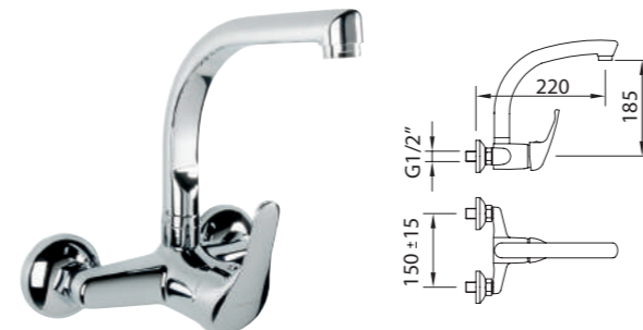
Mezclador con aireador, caño conformado giratorio. Mixer with aerator, swivel tube spout. Mitigeur évier mural, bec orientable façonné, aérateur
