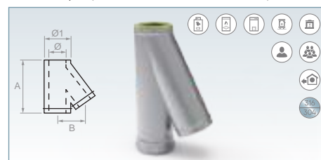
Te 45° sin tapón (Inox 316-Interior / Inox 304-Exterior)
