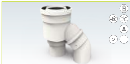
Adaptador biflujo (Ø80/Ø80) a coaxial (Ø80/Ø125)
