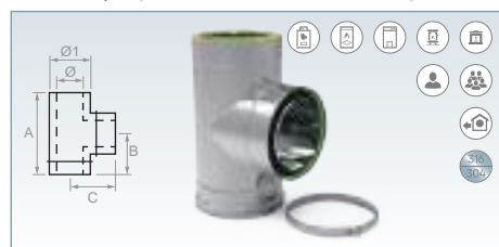
Te 90° sin tapón (Inox 316-Interior / Inox 304-Exterior)
