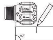
**2** Marcar la profundidad de la instalación del tubo. La profundidad correcta está indicada en cada accesorio.
