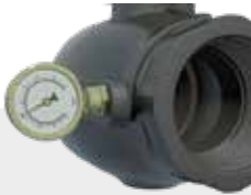
Prueba de presión para controlar la presión del sistema.
