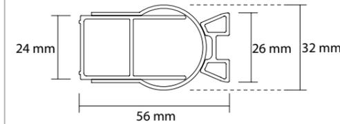
El conjunto de perfiles en recto tiene una medida de 56 mm. El ancho del perfil a pared es de 24 mm, mientras que el perfil que marca los grados tiene un ancho de 26 mm. El diámetro del perfil circular es de 32 mm.
